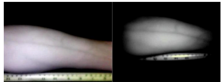
FIGURA 3. Imágenes capturadas con las cámara modificada; 3a Imagen sin filtros, 3b Imagen con filtro IR.
