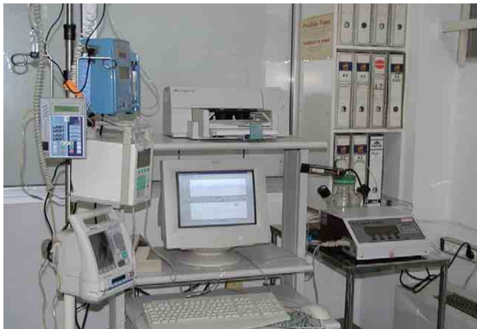
Figura 4. En la parte inferior derecha: Analizador de bombas de perfusión. En la parte izquierda: soporte con las bombas en estudio.
