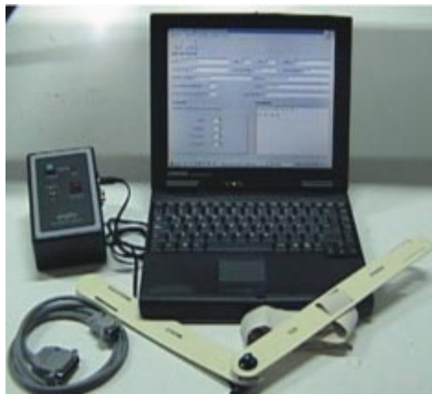
Figura 3. Fotografía del sistema de evaluación de la espasticidad muscular.
