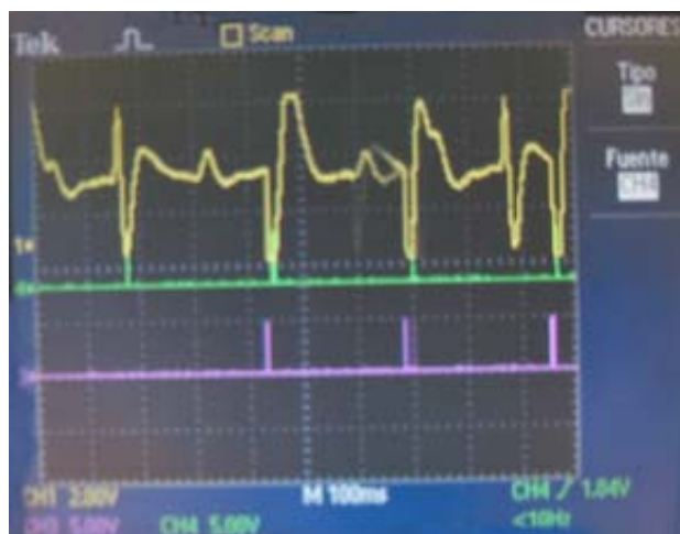
Figura 4. Funcionamiento del marcapasos en cobayo. El trazo superior muestra el electrograma, el trazo de en medio la detección de actividad cardiaca y el trazo inferior la estimulación del marcapasos.
