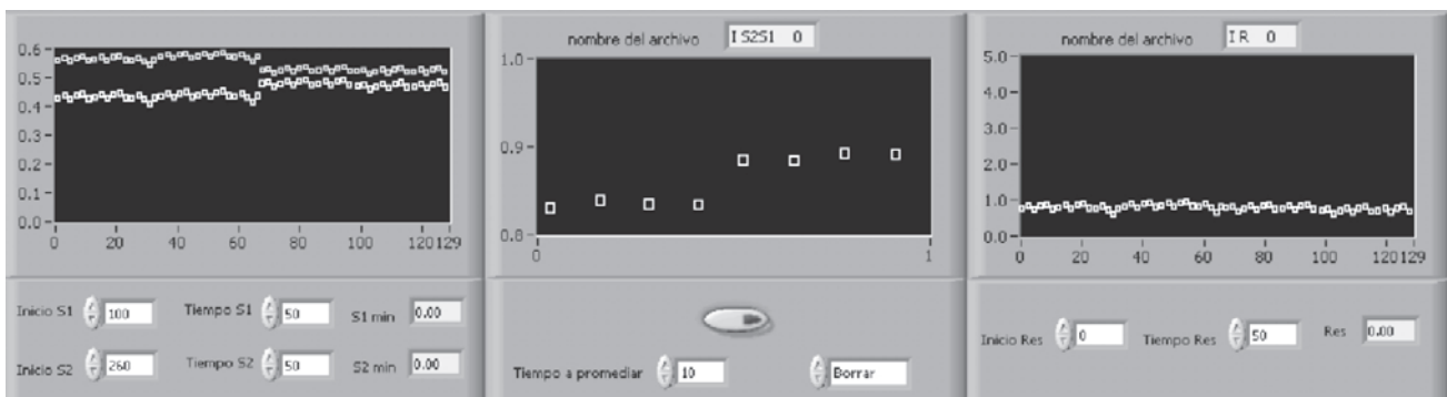
Figura 11. Detalle de la interfaz del usuario donde se muestra la pantalla en donde se realiza el análisis en línea de la variación de los eventos sinápticos provocados (corrientes o voltajes). En la primera pantalla, se grafica la amplitud del primero y segundo eventos sinápticos, durante la estimulación con pulsos pareados. En la segunda pantalla se observa el promedio de diez puntos de la relación entre las amplitudes de los potenciales sinápticos provocados (segundo/primer). La tercera pantalla despliega la resistencia de entrada de la célula durante el experimento; lo que permite dilucidar si hay efectos postsinápticos.
