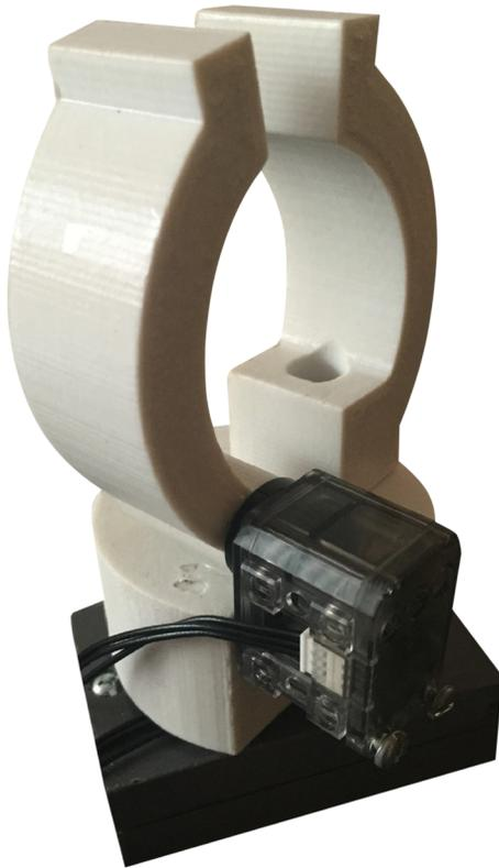
**FIGURA 26.** Prótesis fabricada con la impresora 3D CubePro®.
