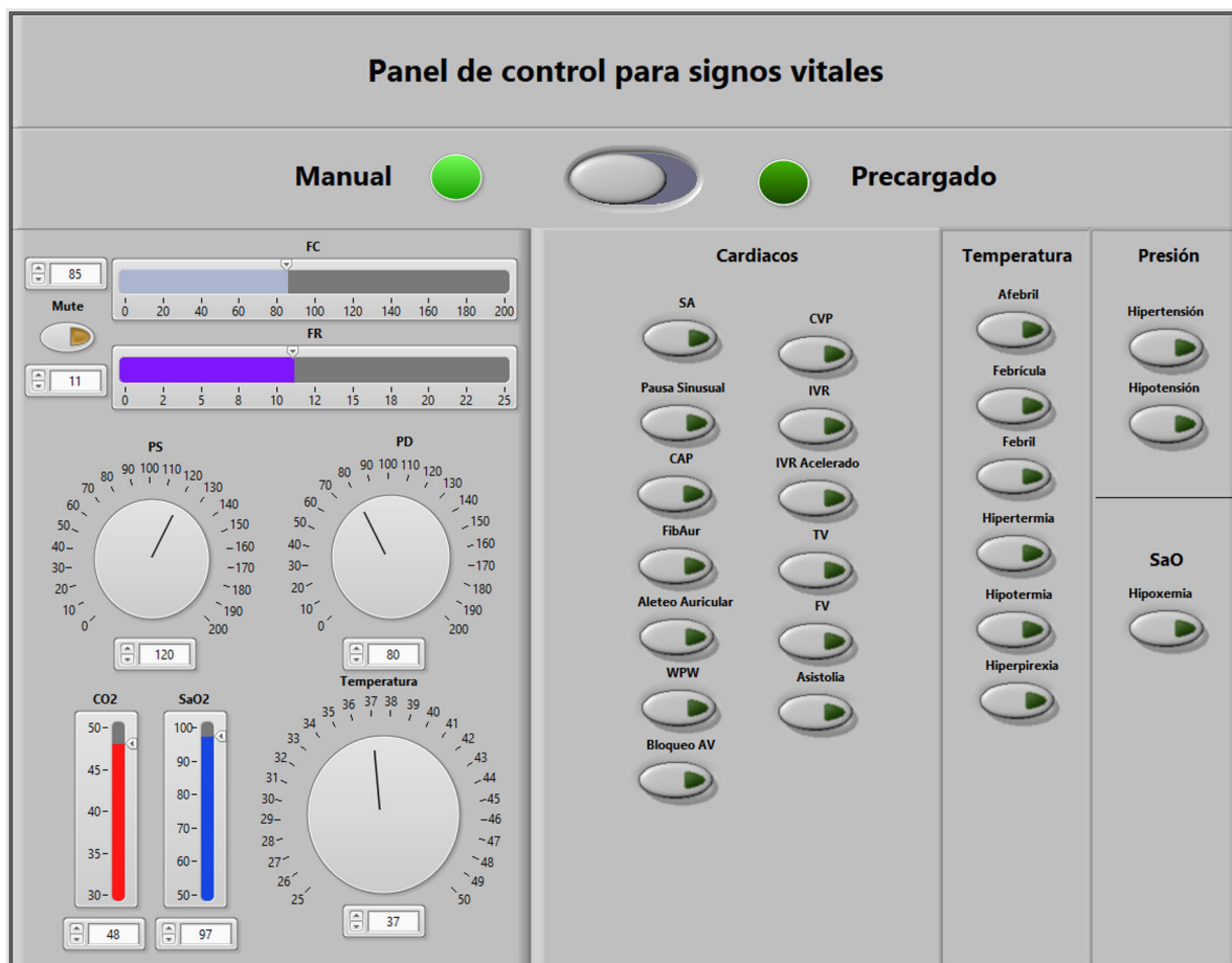
FIGURA 6. Módulo de control en modo manual, utilizado para la personalización y ajuste de los parámetros fisiológicos según los requerimientos específicos del entrenamiento.
