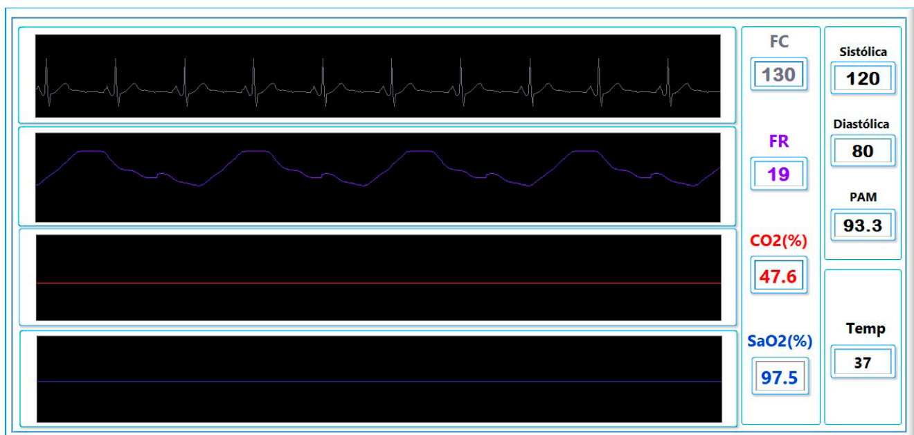
FIGURA 7. Módulo de visualización asociado al módulo de control, que muestra en tiempo real los parámetros fisiológicos ajustados, permitiendo la interpretación y análisis de los signos vitales.
