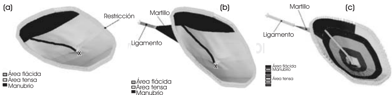
Figura 3. Modelos geométricos de la membrana timpánica. En (a) modelo isotrópico sin restricción de martillo; mientras que (b) y (c) son los modelos isotrópicos con restricción de martillo y ortotrópico, respectivamente.
