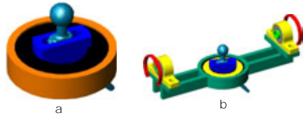
Figura 11. a) Rodamiento y dispositivo de sujeción de la prótesis, b) Ensamblaje del rodamiento en la barra transversal del soporte.
