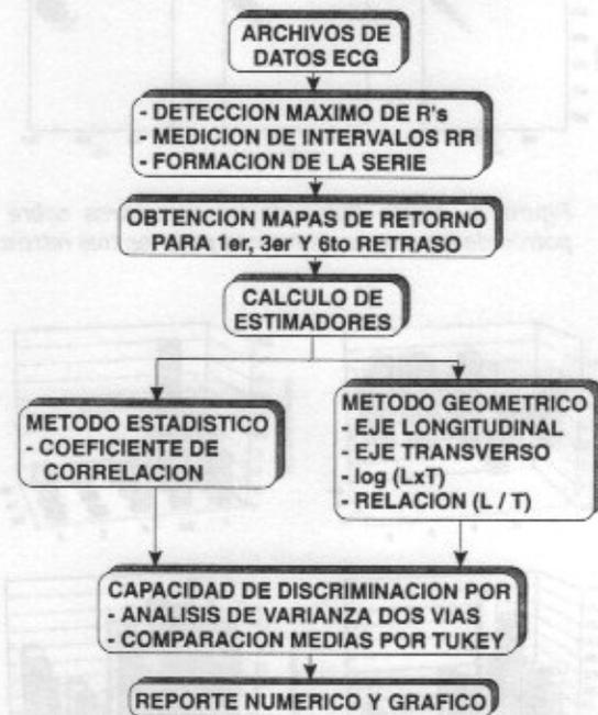
Figura 3. Esquema a bloques del algoritmo utilizado para el procesamiento de los archivos del ECG.
